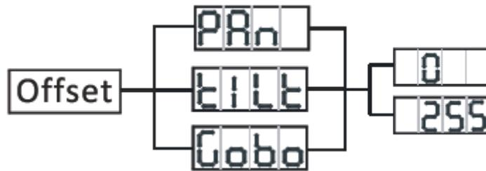
Per accedere al sotto-menù di regolazione offset, premere il pulsante ENTER per almeno 5 secondi. In questo sottomenù è possibile regolare la posizione home di rotazione e brandeggio e della ruota gobo.
